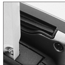
写真2 m505がCard Adapterを背負うかたちになるが、CFカード型PHSを装着していても、SDカードスロットへのアクセスは問題なし
