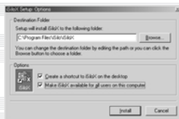
図3 iSiloXのインストール先ディレクトリの設定を行う。デスクトップへのアイコン作成、マシン上のユーザーすべてで利用できるかどうかの設定などを行う。デフォルトでは一人のユーザーのみをサポートしているが、複数台で利用する際は、これらのオプションを設定する必要がある
