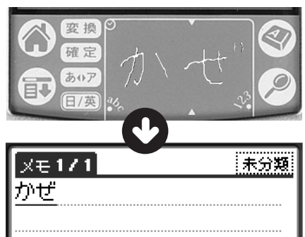
図1 次の文字を書き始めると認識が開始する。認識可能な文字は清音、濁音、半濁音などを含めたひらがな81文字と4つの記号となっている(上の写真はイメージ)
