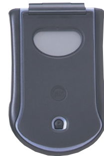
m500シリーズと同じユニバーサルコネクタを搭載。m100用の周辺機器は使えないが、m500用の周辺機器がそのまま流用できる
