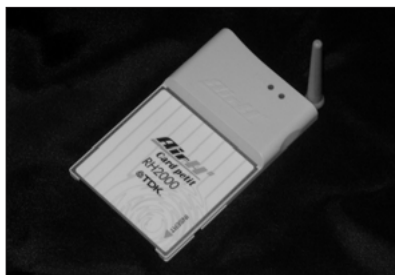
図5 TDK製のAirH"用CFカード。AirH"の32Kパケットとフレックスチェンジの両方式に対応。このほか、32Kパケット専用の製品をNECが販売している
