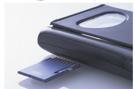
m125の大きな特徴であるSDカードスロットは本体の左側面に搭載されている。SDカードを挿入すると4ミリほどはみ出す
