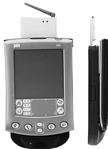
写真1 CFカード型PHSとCard Adapterを装着した状態。ひと回り大きくなり、厚みも約35mmとm505の2倍近くに達する
