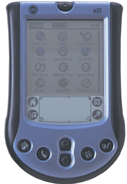
m500シリーズと同じユニバーサルコネクタを搭載。m100用の周辺機器は使えないが、m500用の周辺機器がそのまま流用できる
