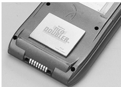
写真2 Prism本体背面の内蔵バッテリー付近にNEO DOUBLERを装着。Prism本体をキズつけないように、付属の粘着シートを両者の間に挟んでおこう
