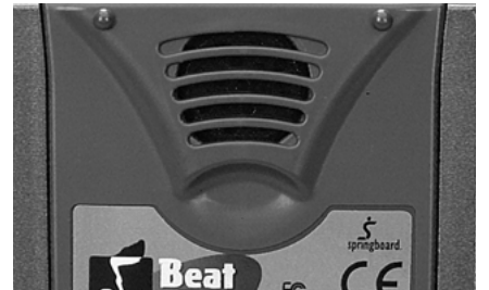
写真 Beat Plusのスピーカー部。出力は0.2Wでモノラル仕様となっている。ステレオを楽しむならばヘッドホン装着しよう
