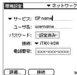
図1 「環境設定」の「ネットワーク」でプロバイダー情報を設定する。さらに「詳細...」ボタンをタップし、初期化コマンド「ATZ」と入力し、速度は「57600bps」程度に設定しておこう
