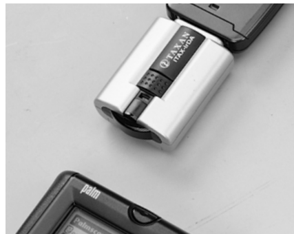
写真 iTAX-IrDAとPalmデバイスの赤外線ポートを向かい合わせにしたところ。NTTドコモのデジタル携帯電話のみが動作保証されているが、筆者の所有するJ-PHONEの「J-SH02」でも使用できた
