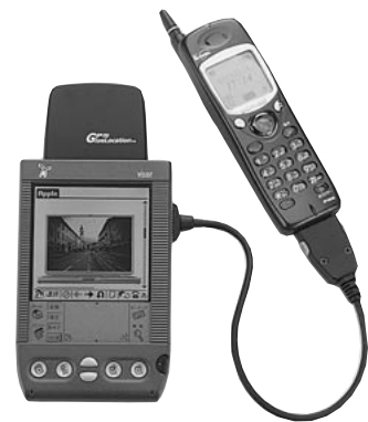
写真 800MHzの携帯電話と接続することでインターネットへアクセスできる。1.5GHzの場合、GPSに干渉するため対応機種外
