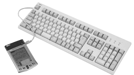
写真1 HATcker、Palm Vx、PS/2インターフェースのキーボードを装着したところ。使い慣れたキーボードでPalmへの文字入力作業が可能になる
