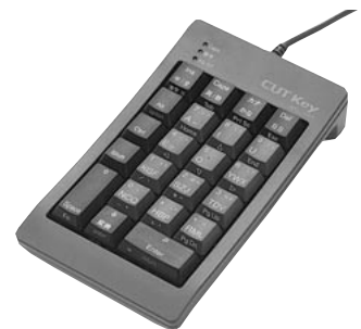
写真2 CUT Keyは、NTTドコモの「Pacty」やPocketPCの「G-FORT」にも標準採用され、PDAにおける文字入力機器として注目を集めている
