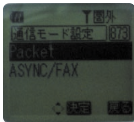
写真 対応端末の側では必ず「通信モード設定」を「Packet」に設定する必要がある
