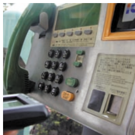
写真 赤外線ポートとは約5~15cm程度の距離を保つのがコツだ
