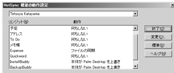
「HotSync 機能の動作設定」を選択すると、現在インストールされているコンジットがリスト表示される。標準以外のコンジットがあることがわかる
