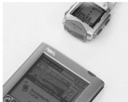
写真 WQV-1Dを通信モードに切り替え、両者の赤外線ポートを向かい合わせてPalm側へ画像データを送信する。両者を距離10m以内、角度15度以内に保つ
