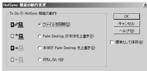
コンジットの設定画面。ファイルの同期、上書き時の方向の選択などが可能だ。コンジットの種類によって画面は異なる
