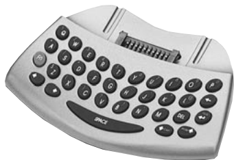
写真1 G300はASCII配列で、35個のキーを備えている。「Fn」キーと組み合わせることで、「Tab」「CAP」キーやテンキー、記号の入力にも対応
