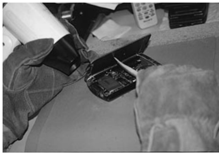
写真1 ボディーにネジがない機種は、接着剤で接着されている。背面パーツを家庭用のドライヤーでゆっくり温めながら慎重に外す
