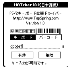
図 ドライバーの画面。HATckerは、このほかにバーコードの読み取り、学習リモコンとしての機能も備えている。詳細については、開発元の米タップスプリング社のWebサイトを参照してほしい。
