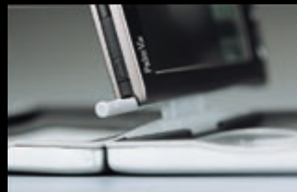
ヒンジに連動したバーを、Palm VxやWorkPad c3のスタイラスホルダーに挿して固定する。形は似ているが、Palm m500や同m505には対応していない
