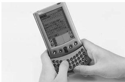
写真2 指だけでキーボードとその上部に装着しているPalmを支えるため、かなりの負担がかかる。安定した入力環境を実現すべく製品の改良を期待したい
