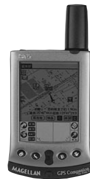
写真 本製品は、米マゼラン社のGPSアダプター「GPS Companion」を日本語版のPalmに対応させたものだ
