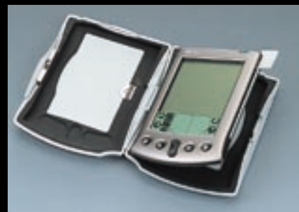
ヒンジに連動したバーを、Palm VxやWorkPad c3のスタイラスホルダーに挿して固定する。形は似ているが、Palm m500や同m505には対応していない
