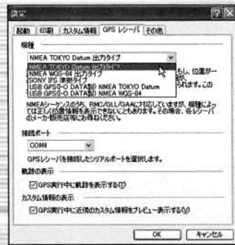
図2 Super Mapple Digitalの場合、測地系の変更は「ファイル」メニューの「設定...」にある「GPSレシーバ」タブの「機種」で行う
