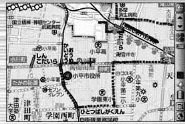
図 PalmGPS2で軌跡を記録、表示しながら一般道を走行。速度を上げても(点線部)、正確に測位できたのがわかる。受信状況がいい道路はGPS向きなのだ
