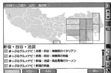
図2 ルートナビの最中に詳細地図の端まで到達しても、隣接エリアの詳細地図がメモリースティックにあれば自動的に切り替わる
