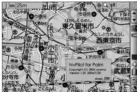
図2 右上の「3D」の部分で測位状態を示す。測位が始まると「X」が点滅し、測位に成功すると受信状況に応じて「2D」や「3D」に変化する。画面中央が常に現在地となる
