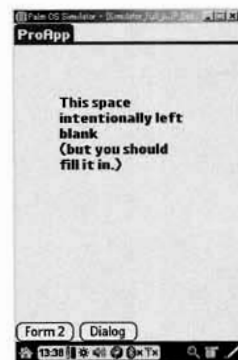
図11 シミュレーターの画面。生成されたPRCファイルをドラッグ&ドロップすれば実行される
