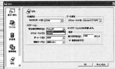
図1 プロアトラスW3の場合、測地系の変更は「ツール」メニューの「設定...」で「GPS」ボタンを選び「受信機の測地系」で行う
