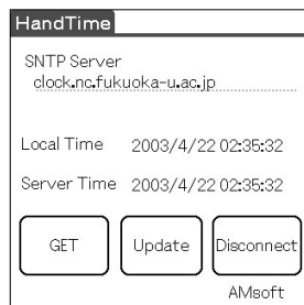
図3 HandTimeを使うと、Palm デバイス単体でネットワーク上の「SNTP (Simple Network Time Protocol)サーバー」を利用して時刻調整ができる
