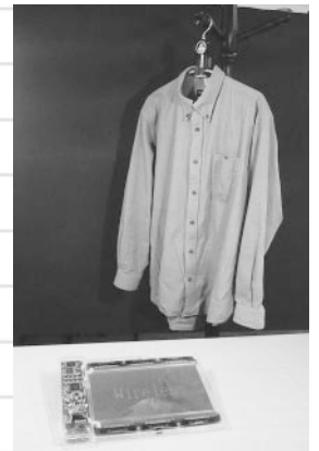
写真2 ハンガーに服を掛けることでハンガーのゼンマイに重力がかかり発電する。この発電によって信号が送られ、信号を受け取った部屋のセンサーが作動して電気が自動的に点灯するといったことができる
