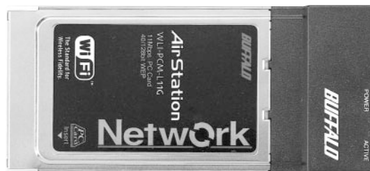
写真1 PRISMチップを搭載した㈱メルコの無線LANカード。製品によって搭載されているチップは異なる。今後はすべての無線LAN規格に対応したPRISM Duetteチップを搭載した製品も登場するだろう
