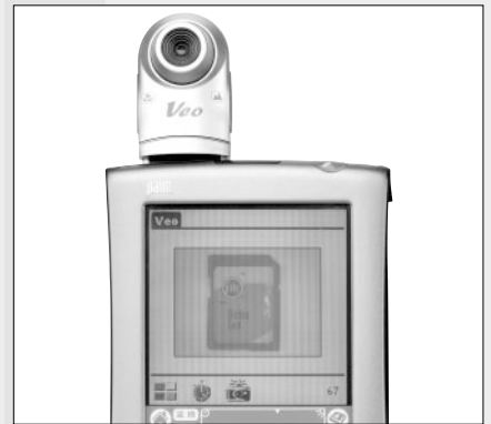
写真 Photo Travelerをm505に装着した様子。例によってカードスロットに入る部分の強度がやや不安だが、神経質になるほどではない
