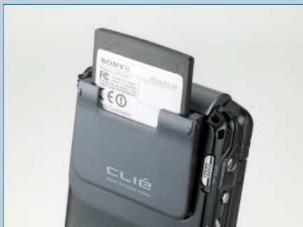
写真1 右側のスライドスイッチを下げるとCFカードスロットが開く機構を採用。通信カードだけでなく、CFメモリーカードも利用できるようになった
