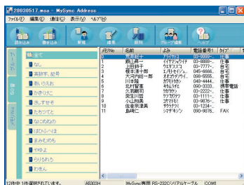
図2 アドレスデータは、一括してファイルに保存される。「読み込み」「書き込み」ボタンでデータの転送を行う
