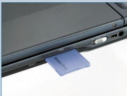
写真2 メモリースティックスロットは、CFカードスロットとカメラ機構の変更から、NZと同様、本体右側面に移動。メモリースティックProに対応する
