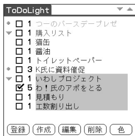
図5 左端に三角があるのが、グループ化された「親項目」。この三角をタップすることによって、子項目を開いたり、畳むことができる
