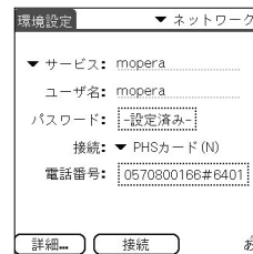
図1 P-in Free 1SをCLIE NX/NZシリーズで利用するときの設定。「PHSカード(N)」を選択して、電話番号には@FreeDのアクセスポイントの番号に「#6401」を追加。64Kbpsで接続できないエリアの場合には、「#3201」を付加
