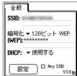
図 付属の通信設定ソフト「Guyver Config」を起動して、SSID、WEP、IPアドレスなどを設定する
