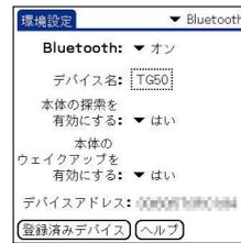
図1 Bluetooth機能のオン/オフは、「環境設定」メニューのBluetoothのパネルで行う。「本体のウェイクアップを有効にする」がオンになっていれば、電源オフの状態でも自動的に起動してファイルを受信できる
