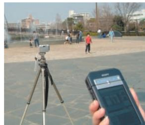
写真2 「Cyber-shot DSC-FX77」をNZ90で操作。NZはカメラに向けなくてもよい
