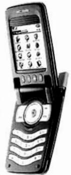
GPRS方式(900/1800/1900MHzの3バンド対応)による通信機能を搭載しているが、日本では使用できない
