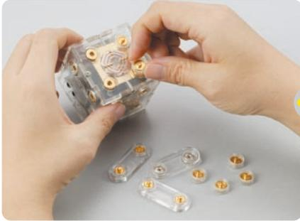
ブロックとブロックの接合には、洋服のスナップのような「ジョイントボタン」を使う。パッチとはめ込むと回路がつながる仕組みだ
