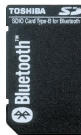
写真3 純正のBluetoothカード(図1万9800円)。SDカードよりも15mmほど長い
