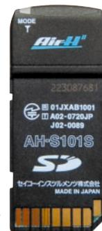
写真4 セイコーインスツルメンツ(株)製のAirH"カード。32Kbps通信に対応する
