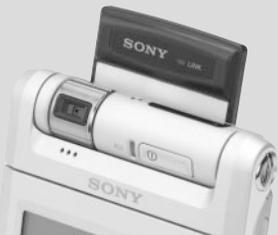
Palmから直接インターネットに接続するには、主に通信カードを使う方法と、携帯電話やPHSを用いる方法がある。拡張スロット付きの機種なら、AirH™(写真)などの通信カードがオススメ。拡張スロットがない場合は、基本的に通信アダプターや携帯電話接続用のケーブルが別途必要になる。
