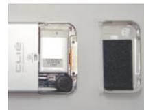
写真2 T400に電ビタを張った状態。表面をバッテリーの面に向ける。わずかなすき間があれば装着できるが、場所によっては部品と干渉するので注意したい
