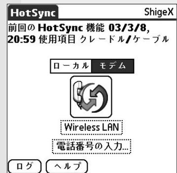
図1 無線LAN経由でHotSyncを行うには、「オプション」メニューの「モデムHotSyncの設定」で「ネットワーク」を選択し、接続方法に「WirelessLAN」を指定する
