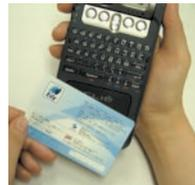
写真 NZ90だけに装備されているFeliCaリーダー。専用の読みとりアプリケーションを起動してからSuicaかEdyカードをリーダー部にかざせば、瞬時に内容を読み取る
