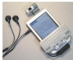
写真2 T650にメモリースティックカメラモジュールとハードウェアキーボード、ヘッドホンを装着。残念ながら、通信アダプター経由ではキーボードが動作しなかった
