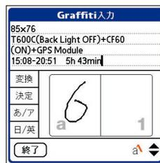
図4 グラフィティーボタンを押すと呼び出される、標準搭載のソフトグラフィティー機能。フィールド外ではこの画面自体を呼び出せないで、ショートカットの入力には使えない
