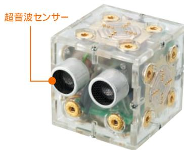
左右の目玉のように見える部分から超音波を出す! 超音波が戻ってくる時間により距離を測ったり、プログラム実行のトリガー(引き金)となる
