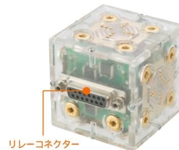
コネクタに外部機器を接続して使う。カーネルブロックのタイマーで設定した時間にスイッチを入れたり、さまざまな機器を制御できる「リレー回路」を4個内蔵
