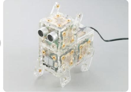
耳や手足を付けて、子犬(?)ロボットが完成! 尻尾のようにみえるのは、ACケーブル。目玉は2つの超音波センサーだ
