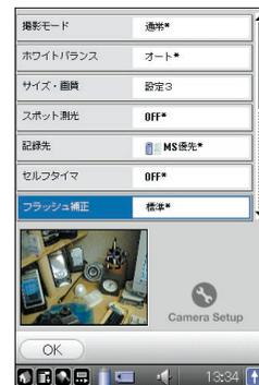
図3 NZ90に用意されている撮影用設定ソフト「CLIE Camera S」は、マニュアルも選択でき、撮影モードやフラッシュの光量補正などの機能を備える
