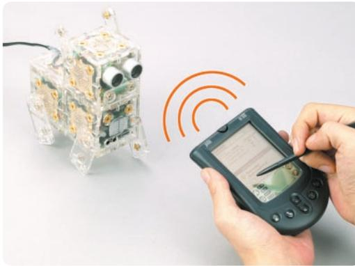
「Neurocube」を起動すると、Palmの赤外線ポートが向かい合うように「bind」をタップすると、ロボットの情報がPalmに送信される。
