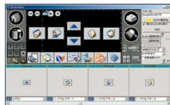
図3 ドラッグ&ドロップで配置した各ボタン画像に、プルダウンメニューで機能を割り当てる。デフォルトのシルクボタンやハードボタン以外にも、オーディオリモコンのボタンやテキストのコピー&ペースト、テンキーなどの機能をボタンに設定できる
