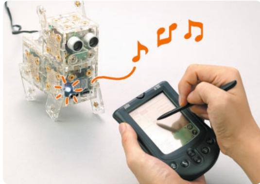
プログラムが完成したら、ロボットに赤外線通信で送信しよう。意図したとおりうまく動かさず試せるので、試行錯誤しながら楽しむ
