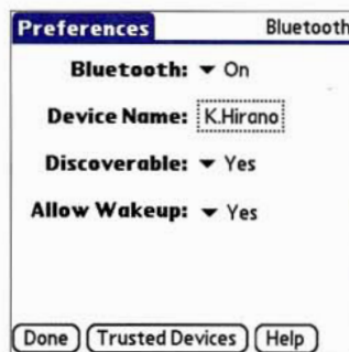
図1 Bluetooth機能の設定画面。外出時などは、ほかのBluetooth機器に反応させないために「Discoverable」をオフにしておくこと。
