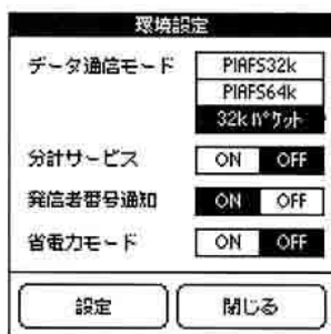
図2 付属ユーティリティで省電力モードをオンにすると、MODEランプが完全に消灯する
