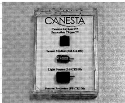
写真1 米カネスタ社が研究・開発したバーチャルキーボード用のチップセット
