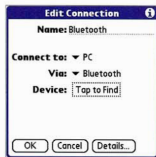
図2 HotSyncの設定画面。詳細設定にあたる「Details」をタップすると、HotSync時の通信速度とフロー制御の設定画面に移行する。
