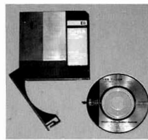
写真 EBXAは取り出し可能な8センチのCD-ROMを専用キャディーに納めて提供される。一方、EPWINGは12センチのCD-ROMが普通だ
