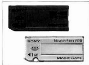
図 上がメモリーセレクト機能を搭載したメモリースティックで、背面には2つの128MBメモリーを切り替えるスイッチが付いている。下は1GBのメモリースティックPro
