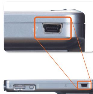
本体左側にUSB mini-Bコネクタを搭載。USBポートはUSBスレーブポートであり、マウスやUSBモデムケーブルを利用することはできない
