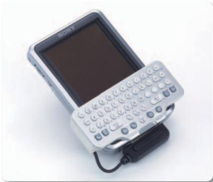
Tシリーズと同じように装着できるミニキーボード。SL10はTシリーズと横幅がほぼ同じため、ミニキーボードはしっかりと狭むように固定できる
