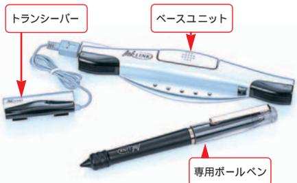
図1 ベースユニットの左右に赤外線を受光部があり、専用ペンの先端までの距離を三角法で読み取る。実はとっても賢い仕組みを備えているのだ
