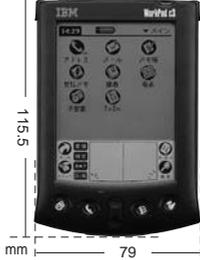
Palm OS 3.5搭載。モノクロ16階調表示、リチウムイオンバッテリーと基本仕様はPalm Vxと同等。付属ソフトはビジネス向けのものが用意されている
