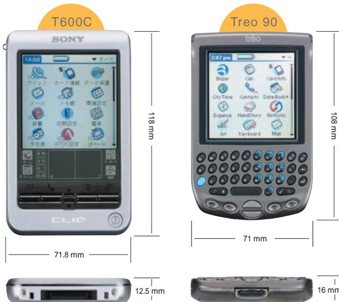
Treo 90はノーマルレゾリューション液晶を搭載。一体感のあるカバーには透明な窓があり、カバーを開けずに表示内容を確認できる。液晶はバックライト付きSTN液晶で、輝度調整が可能だ。利用時には常にライトが点灯する。アプリケーションボタンはカバーを開く前に押せるので、今日の予定やTo Doを確認するTodayのようなアプリケーションを確認するだけなら、カバーを開ける必要がない
