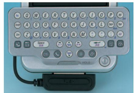
図2 キーボード裏側のストッパーでCLIEに固定する。上下方向に自由にスライド可能なので、使いやすい位置にセットできる
