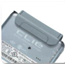
付属のソフトカバーはT600Cの方式をほぼ踏襲。ソフトカバーの固定方法は、左右両端2カ所をロックするのではなく、上方向にスライドする1つのロックに変更された
