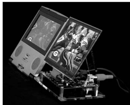
写真2 LCD(左)と有機ELディスプレイ(右)の視野角の比較画像。有機ELディスプレイのほうがはっきりとした再現力で、明らかに見やすい
