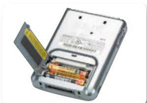
背面の少しせり上がった部分に、単4形乾電池2本を収納する乾電池ボックスが搭載されている。扉の開閉は、4mmほど右にスライドしてから左端を支点にして開く。扉が別パーツではないので紛失ににくい
