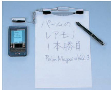
図2 使用例。手持ちのレポート用紙(A4サイズ)と組み合わせてみる。ベースユニットがクリップの機能を持っているので、簡単に紙を固定できる
