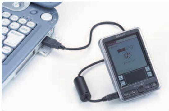
SL10では、付属するPortable USB HotSync cableでパソコンを接続してHotSyncを行う。しかし、同ケーブルにはHotSyncボタンがないため、CLIE上で手動でHotSyncを起動しなければならない
