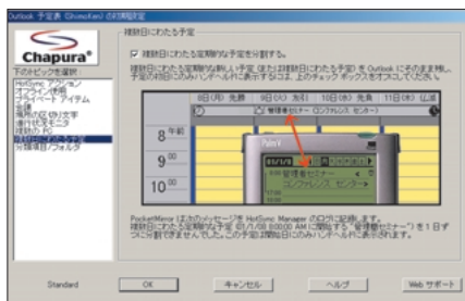
図6 HotSyncアクション：シンクロのモードを設定する画面。1回のみ設定と、永久的なアクションの2つに分かれる。使い分けの方法はPalm Desktopと同様
