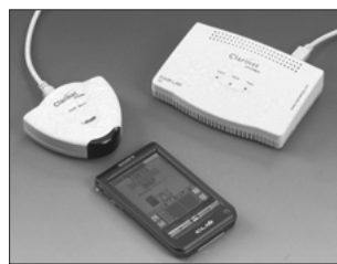
図7 「EthIR LAN」を DHCP 環境下の LAN に接続することで、Palm などの赤外線ポートを持つデバイスを簡単に LAN につなげられる
