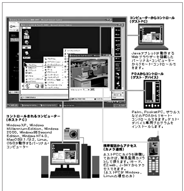
Desktop On-Call概念図。ホストPCに、ゲストPCから、さらに今回のバージョンアップにより、PDA、携帯電話からもリモートコントロールが可能になった
