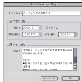
図6 Palm側メールの「ツール」メニューから「Palm Desktopに追加」を選ぶと、そのメールをメモや予定として追加できる。予定はメールタイトルと日時やアラーム設定が加わり、メモはメールタイトルと本文が1件のメモになって転送される
