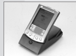
写真4 シーエフ・カンパニー製のイーサネット接続クレードル「Mobile Dox for m500」。ネットワーク経由のHotSyncを可能にする
