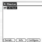
図16 HackモジュールであるSJIS Hackを利用するには、HackMaster互換のX-MasterやTeal Masterが必要となる
