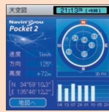
図6 GPS受信中の天空図画面。初めの測位でできるだけ多くのGPS衛星を捕捉しておこう
