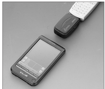
写真2 モードAでの利用図。本体とPalmの赤外線ポートを10~30cmの距離をおいて向かい合わせる。本モードではドライバーのインストールは不要だ
